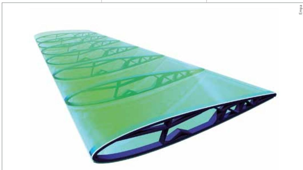
Konzept eines monolithischen Flügels nach dem Gürtelrippenprinzip.
